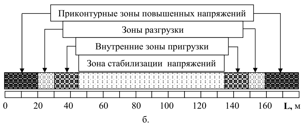
Рис. 2 - Результаты измерений (а) электросопротивления (1), ИЭМИП (2) и характер распределения зон аномальных напряжений (б) в лаве
